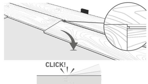
2. Coloque el extremo corto de la lama en ángulo frente a la lama previamente instalada, presione hacia delante y hacia abajo ligeramente.
