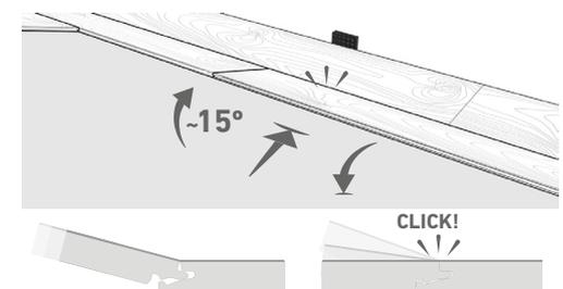
3. Eleve la lama  $\pm 15$  (junto con la lama anteriormente montada en la misma fila) ligeramente empuje hacia delante y hacia abajo haciendo deslizar la pieza para que esta pueda encajar con la anterior en sus enganches longitudinales.
